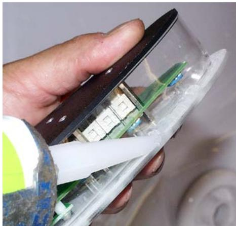
Transparentes, handelsübliches Sanitär-Silikon in einem gleichmäßigen Strang auf den Auflagerand des Bedienteiles auftragen
